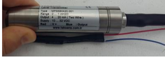
Şekil 11. Hidrostatik su seviye sensörü
