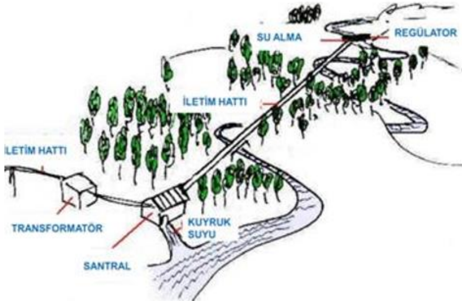
Şekil 5. Kanal tipi hidroelektrik santrali
